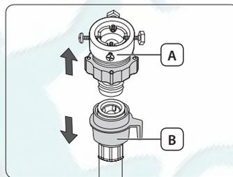
2. С помощью крестообразной отвертки ослабьте четыре винта на адаптере.
