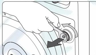
2. Закройте болтовые отверстия с помощью прилагаемых пластмассовых колпачков. Сохраните транспортировочные болты для последующего использования.
