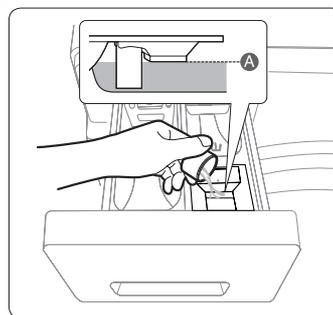
4. В случае использования режима Предварительной стирки загрузите в правый отсек соответствующий объем моющего средства (I).
