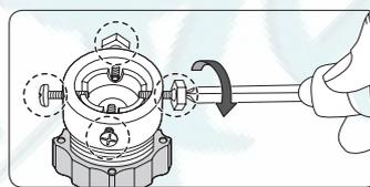
3. Возьмитесь за адаптер и поверните его часть (C) в указанном стрелкой направлении, вывинтив его на 5 мм (\*).
